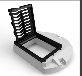
Figure 300: GT 100/4B_S60 socle 900 x 800 mm, excentrique, hauteur 210 mm, classe de charge D400
