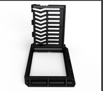
Figure 210: GT 100/4B_40 dimensions 633 x 455 mm, hauteur 85 mm, classe de charge D400
