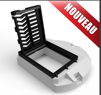
Figure 400: socle 900 x 800 mm, excentrique, hauteur 180 mm, classe de charge D400
