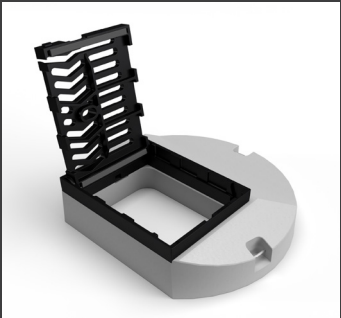
Figure 100: GT Niveau N100S60 socle 800 x 900 mm, excentrique, hauteur 210 mm, classe de charge D400
