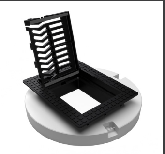
Figure 520: GT Locked-tiltable-self level centrique, hauteur 190 mm, classe de charge D400
