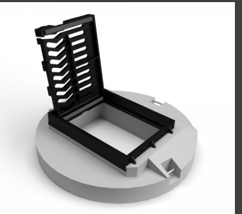
Figure 310: GT 100/4B_S50 socle 900 x 900 mm, centrique, hauteur 210 mm, classe de charge D400
